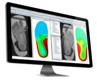
3.AUTOMATISCHE ERZEUGUNG VON PASSENDEN 3D BRANDSOHLEN AUS DER MODELLIERTEN OBERFLÄCHE Möglichkeit, alle Fußformen beidseitig ohne Materialprobleme zu fräsen
